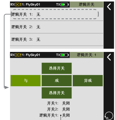
两个开关状态和逻辑开关经过逻辑运算后状态
